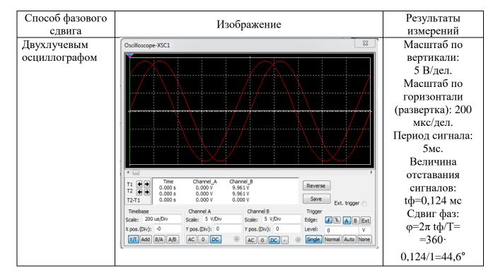
Выводы: Измерения с помощью осциллографа амплитуды, частоты, периода повторения, длительности импульса, длительности и фронта и среза импульса, сдвига фазы возможны, однако в случае применения аналогового осциллографа точность измерения оказывается невысокой и определяется половиной минимального деления экранной сетки, в то время как цифровые осциллографы позволяют устанавливать метки в точке измерения и точность измерения определяется частотой дискретизации измеряемого сигнала.
