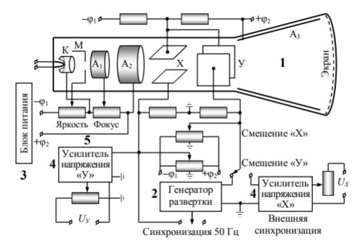
Рисунок 1 Блок схема осциллографа
